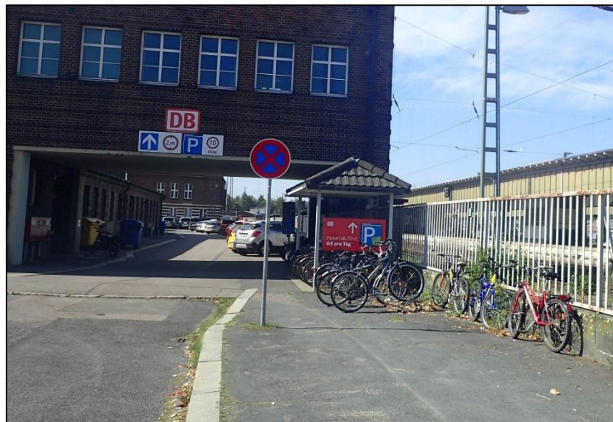
Abbildung 7 Radabstellanlage am Bahnhof Zwickau (unsichere Vorderradhalter, „Wildparker“ am Zaun, Quelle: ISUP 2024)
