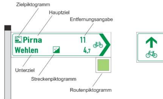
Abbildung 21: Pfeilwegweiser (links) und Zwischenwegweiser (rechts) nach bundesweitem FGSV-Standard der Radverkehrswegweisung (Quelle: ISUP 2024)
